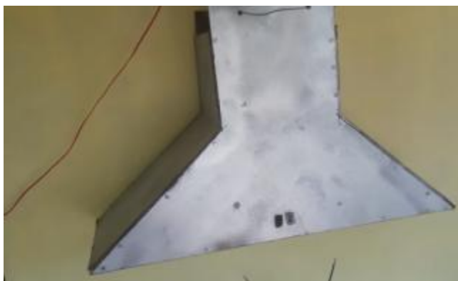
Figure 17. Research Chimney Mini chimney W=30 cm and B=50 cm
