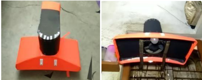
Figure 18. Research Chimney 3, Mini chimney W= 26 cm and B=38 cm.
