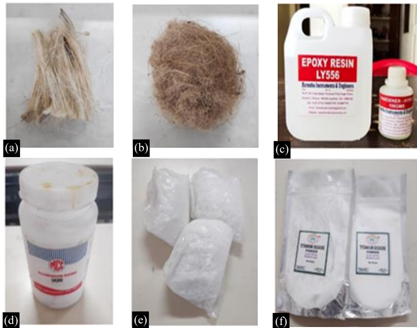
Figure 1. a) Raw Sisal, b) Areca, c) Epoxy resin, d) NaOH, e) Al 2 O 3 , f) TiO 2 Sisal Fiber
