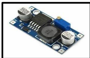
Fig:5 LM2596 DC-DC Buck Converter
